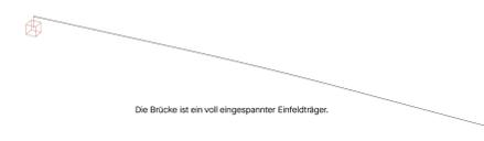
Die Brücke ist ein voll eingespannter Einfeldträger.
