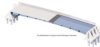
Der Stahlbetondeck ist integral mit dem Widerlager verbunden.
